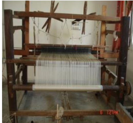
11(d) Loom (production for fabric)
